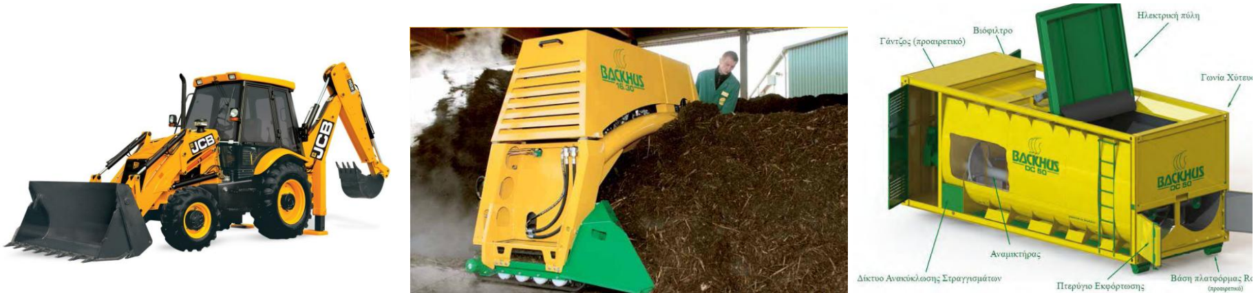
Εικόνα 20. Φορτωτής, Αναστροφέας, Μηχανικός Κομποστοποιητής
